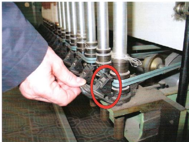
Figura 3 - Ritorcitoio, altro modello - freno "a ginocchio" con guarnizioni doppie per i due labbri della puleggia Figure 3 - Twister machine - brakes with double pressure pads
