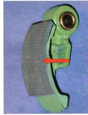
Figura 6 - Ganascia del freno roccatrice smontata: si nota la spessa guarnizione in materiale amiantifero Figure 6 - Brake shoe
