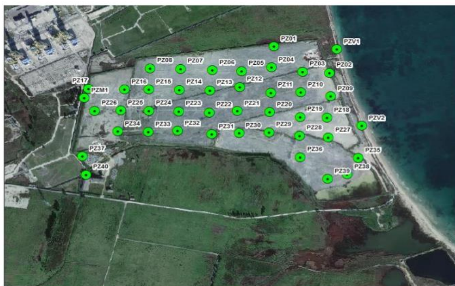
Figura 4-2 Sondaggi ambientali allestiti a piezometri
